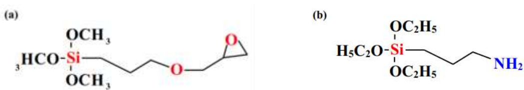
Figure 33 : Formules chimiques des agents de couplage silane (a) GPTMS et (b) APTS
