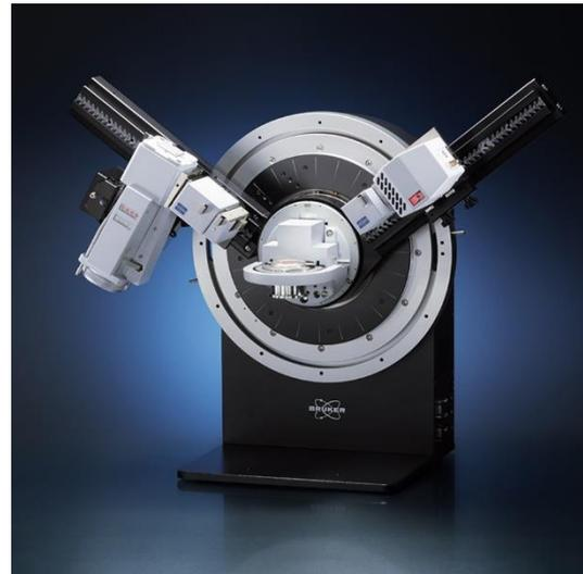
Figure III.10 : Photographie du diffractomètre Bruker D8 Advance
