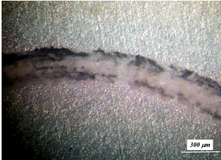
Fig. 11 : Micrographie optique de l'usure de l'aluminium 6061 anodisé avec une épaisseur  $e=22\mu\text{m}$  et  $F=0.5\text{N}$
