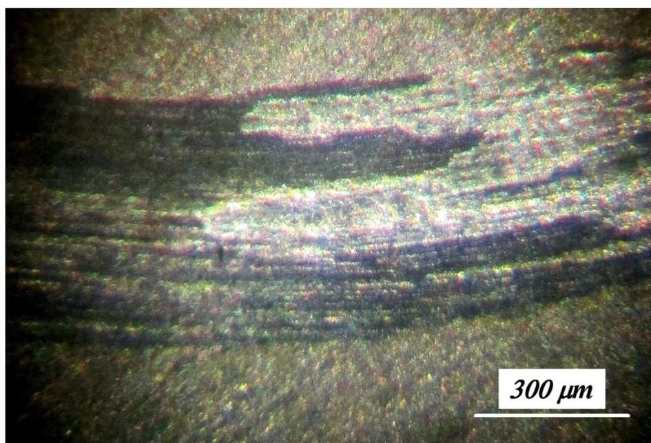
Fig. 14 : Micrographie optique de l'usure de l'aluminium 6061 anodisé avec une épaisseur  $e=10\mu\text{m}$  et  $F=0.5\text{N}$
