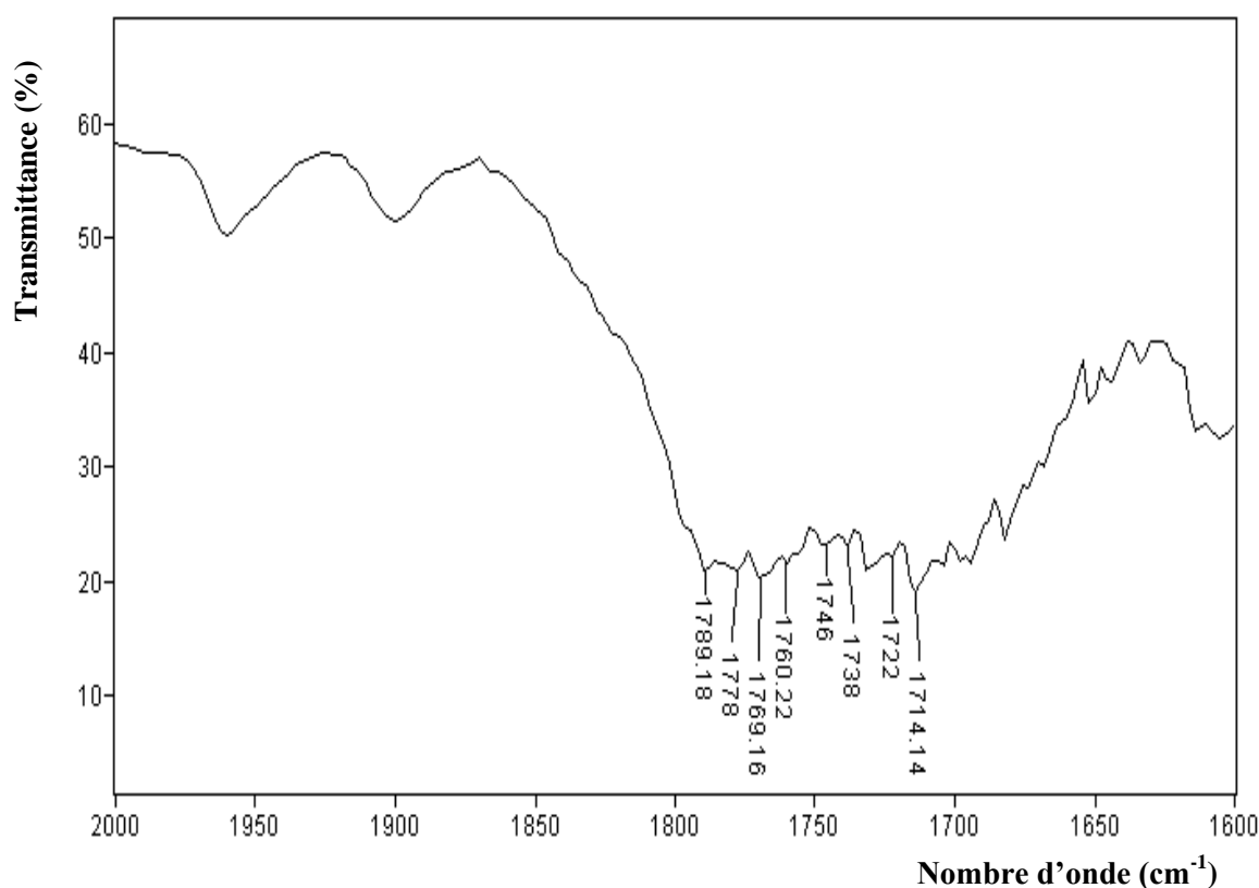
Figure V-8: Spectre infrarouge ( 2000\text{-}1600\text{ cm}^{-1} ) d'un mélange PC/PET (50/50) préparé par malaxage interne en présence de 0.25 pcr de TBOT.
