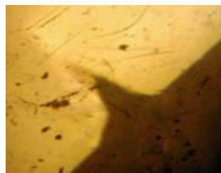
Figure 4.2.16: Micrographie d'une fente sur le composite dentaire
