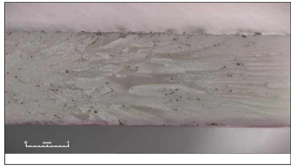
Rupture fragile du PC pigmenté.
