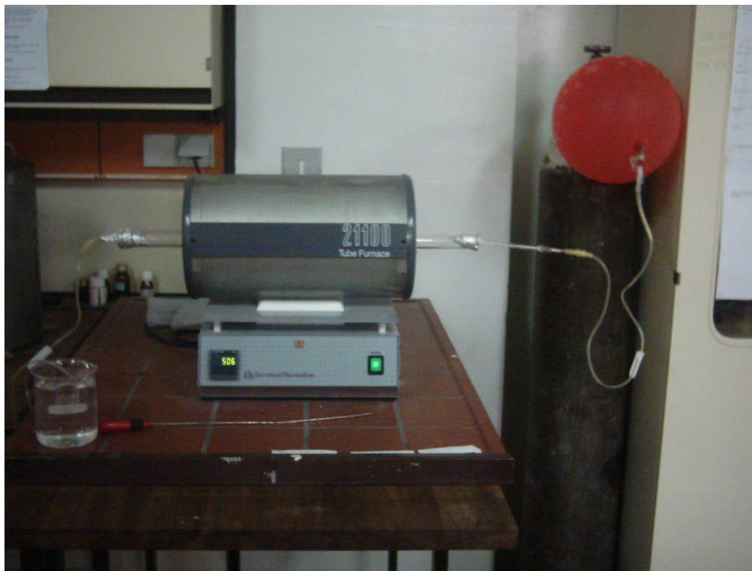
*Figure III-2: Four tubulaire et dispositif de recuit sous oxygène*
