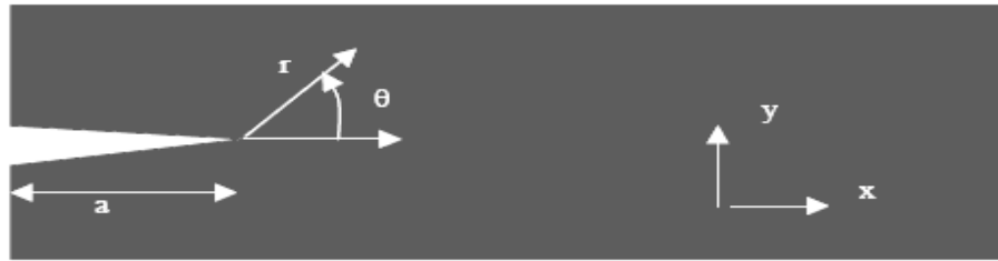
Fig. 2.13 – Représentation conventionnelle d’une fissure de longueur c se propageant dans un solide [FABR 04].
