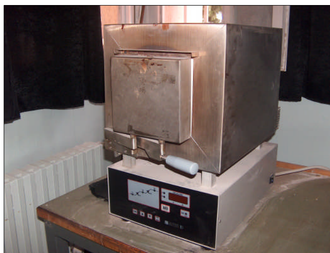
Figure 3.3: Four électrique de traitement
