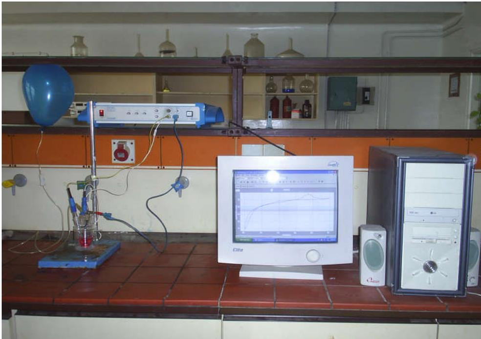
*Figure 2.1: dispositif expérimental (la cellule et le Voltalab 40)*
