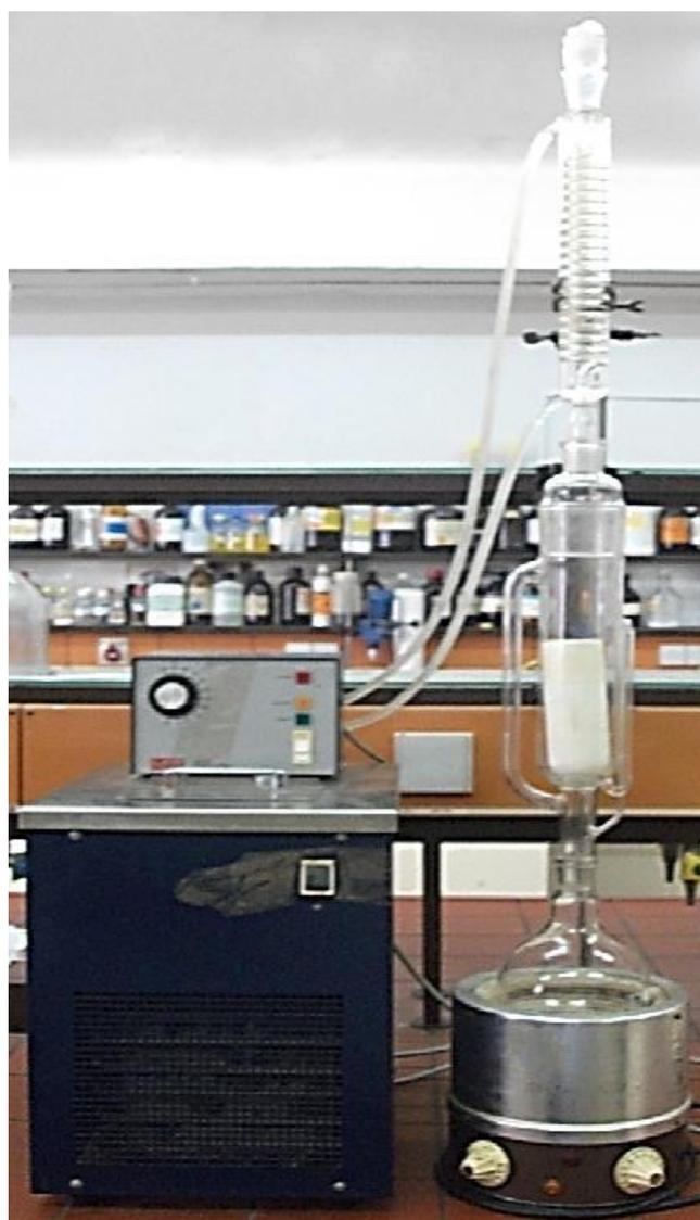
**Figure 11** : Système d'extraction au Soxhlet.
