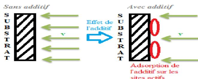
**Figure I.18:** Mécanisme d'action d'un additif par blocage des sites actifs.
