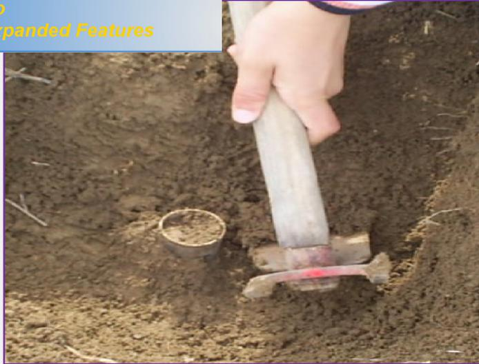
**Annexe 7** : prélèvement du sol pour mesurer la densité apparente.
