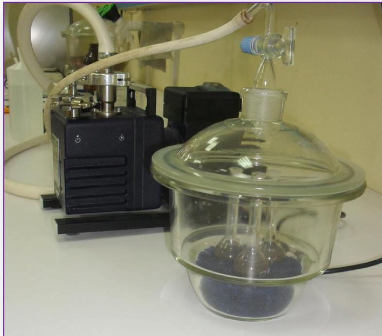
**Annexe 8** : mesure de la densité réelle.
