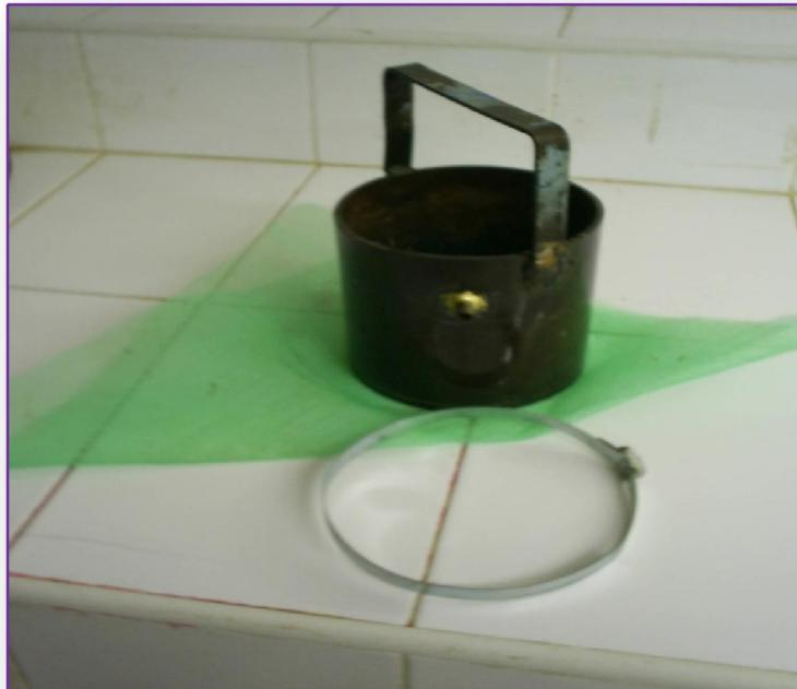
**Annexe 12** : le cylindre utilisé pour mesuré la conductivité
