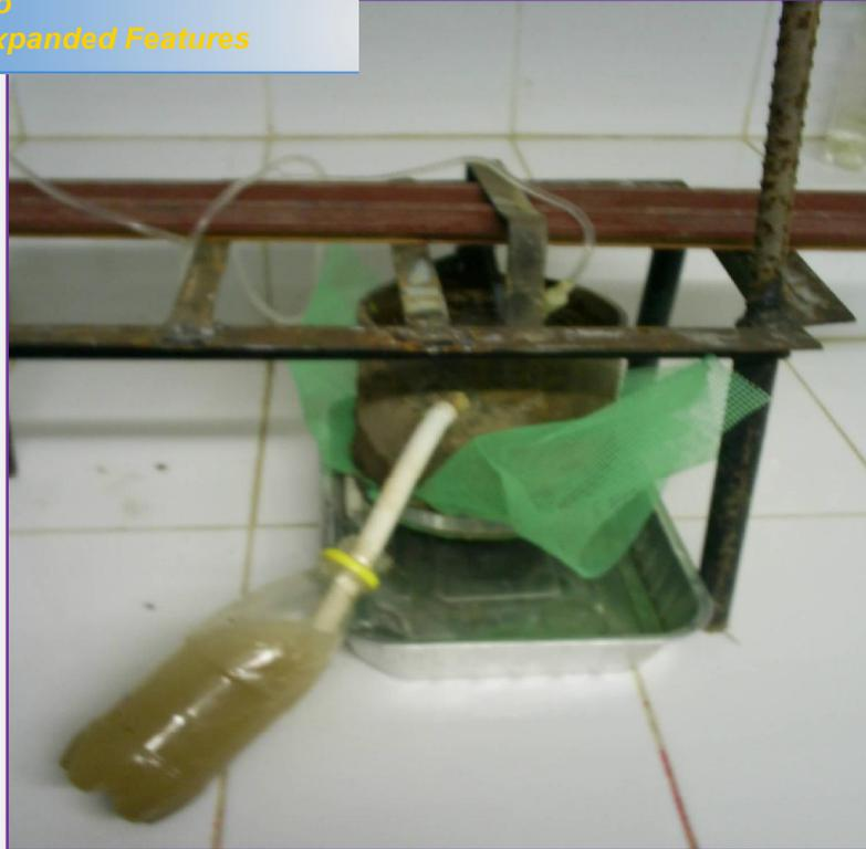
**Annexe 13** : mesure de la conductivité hydraulique saturée au laboratoire.
