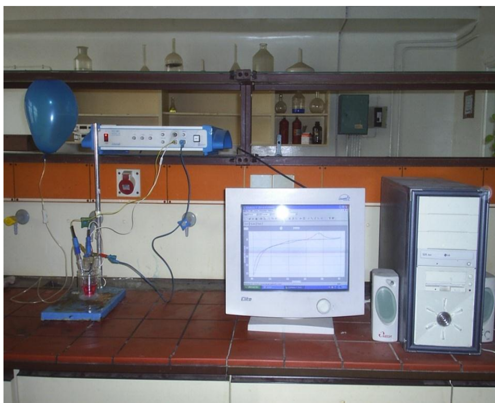
Figure 3.1 : Le montage expérimental du système électrochimique
