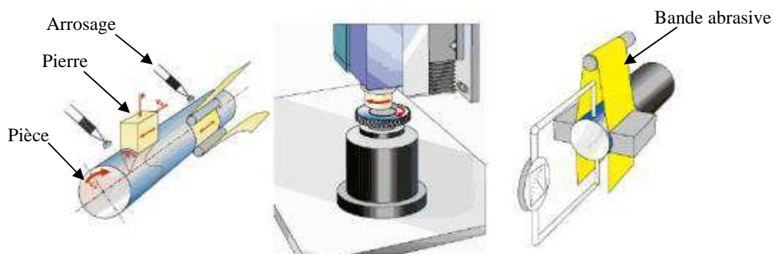
Figure I.4 : Principe de la superfinition [www1].
