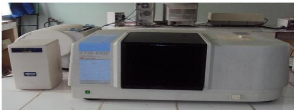
*Figure II.7. Spectromètre IRTF 8400 SHIMADZU.*
