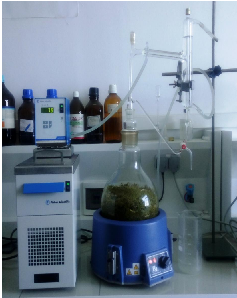
الشكل (25): جهاز التقطير المائي نموذج Clevenger (صورة أصلية)
