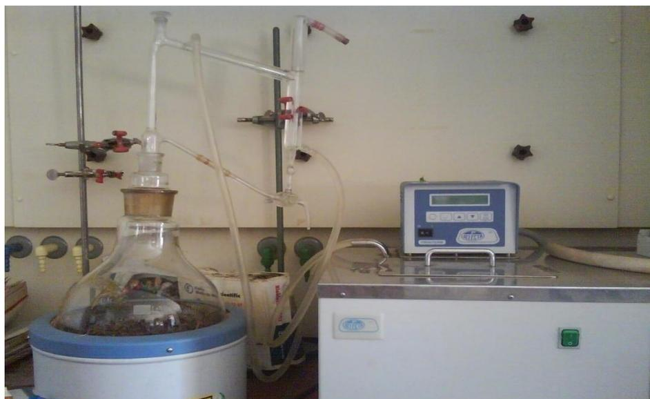
Figure 9 : Appareil de distillation type Clevenger
