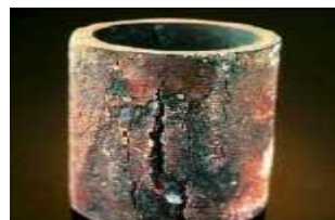
Figure I.12: Cloquage par l'hydrogène d'un acier ordinaire.
