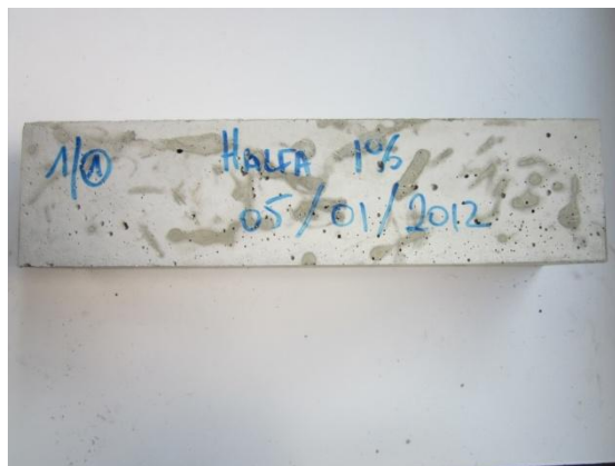
Figure III. 4. Echantillons de bétons de dimension 7x7x28 cm.
