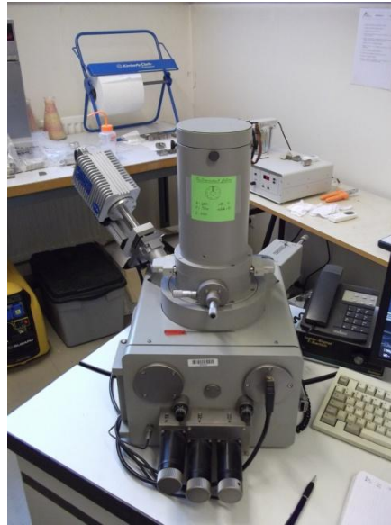
Figure III. 22. Microscope électronique à balayage de L2MGC
