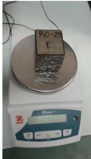
Figure III. 9. Pesée des masses des échantillons
