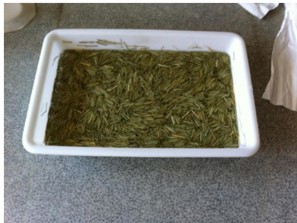
Figure II. 5. Fibre d'alfa immergée dans de l'eau
