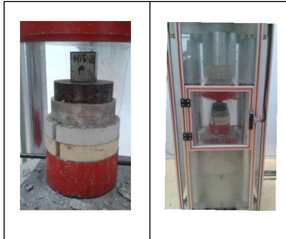
Figure III. 12. Tests de compression simple des échantillons
