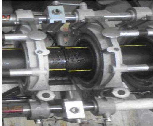
**Figure II-7 :** Soudage des surfaces contaminées par l'eau.
