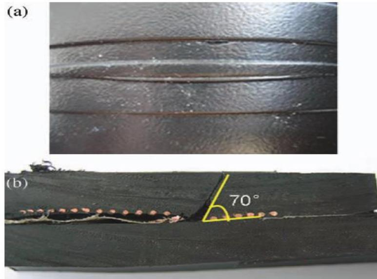
**Figure I-35.:** *Initiation et propagation d'une fissure dans la paroi du manchon sous l'effet de la pression interne : (a) Apparence de la défaillance sur l'extérieur du manchon, (b) Coupe dans la zone de fusion contaminée (Shi et al., 2012).*
