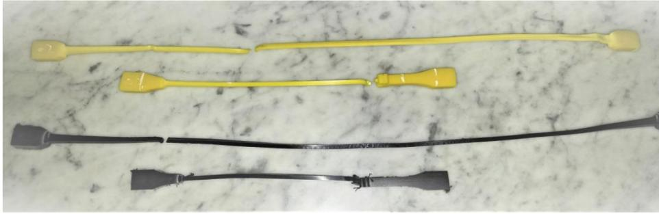
**Figure IV-22** : Rupture des éprouvettes de tubes et de soudures soumises à l'essai de traction.
