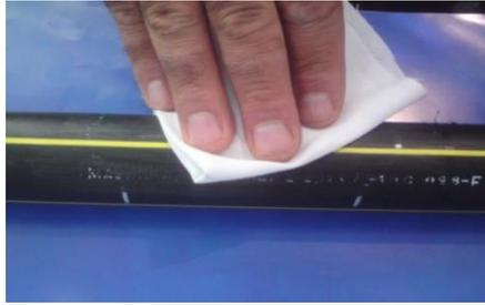
*Figure II-9: Humidification de la surface du tube, à souder, avec le solvant dégraissant.*
