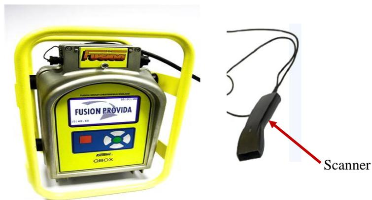
**Figure II-5:** Machine de soudage par électro-fusion de type QBOX (FUSION PROVIDA).
