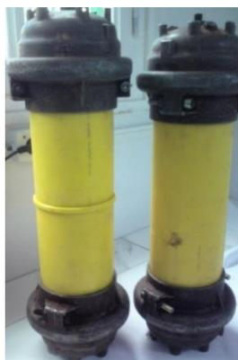
***Figure IV-8: Eprouvettes de tubes soudés et de tube sain préparées pour l'essai de pression hydrostatique.***
