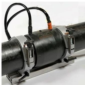
***Figure I-25: Fixation des parties à souder par électro-fusion à l'aide du positionneur.***
