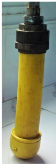
*Figure III-3 : Eprouvette de soudure par polyfusion, préparée pour l'essai de pression hydrostatique.*
