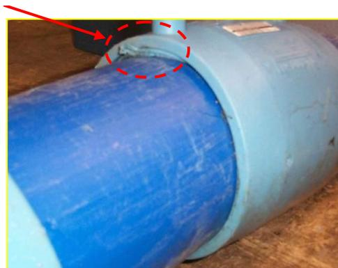
**Figure I-32:** Soudure d'un tube et d'un manchon électro-soudable, obtenue durant un temps de chauffage excessif (Fusion Provida, 2011).
