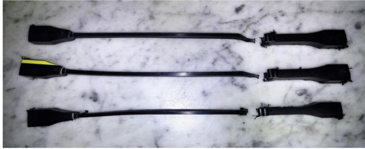
*Figure II-27: Rupture des éprouvettes de soudures bout à bout soumises à l'essai de traction.*
