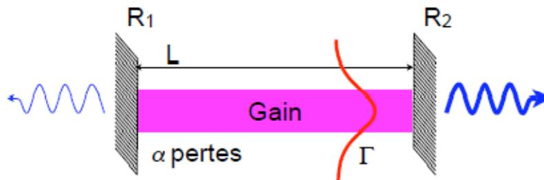
Figure I.12 Cavité optique du diode laser FP
