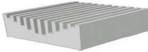
Figure I.3 Réseau apodisé intégré dans un guide d'onde
