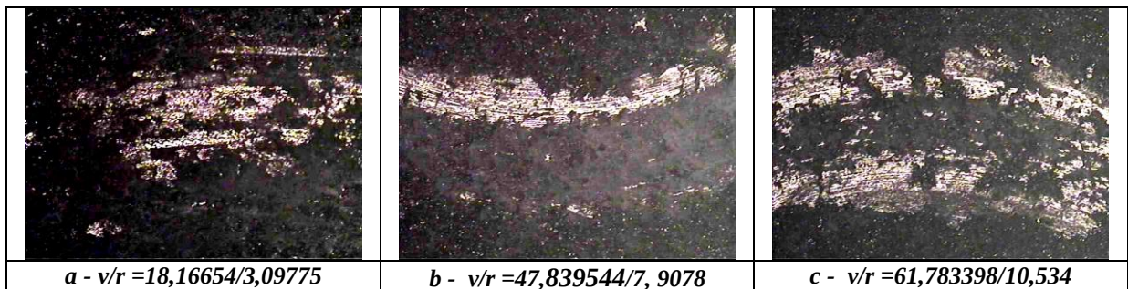
Figure IV.8 : Micrographie optique des pistes d'usure du revêtement composite pour différentes conditions d'essai, G=5x
