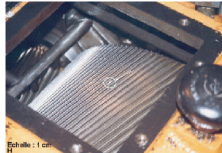
Figure II.14.b Photographie de la dent détériorée par écaillage
