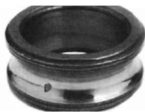
Écaillage de la bague intérieure
