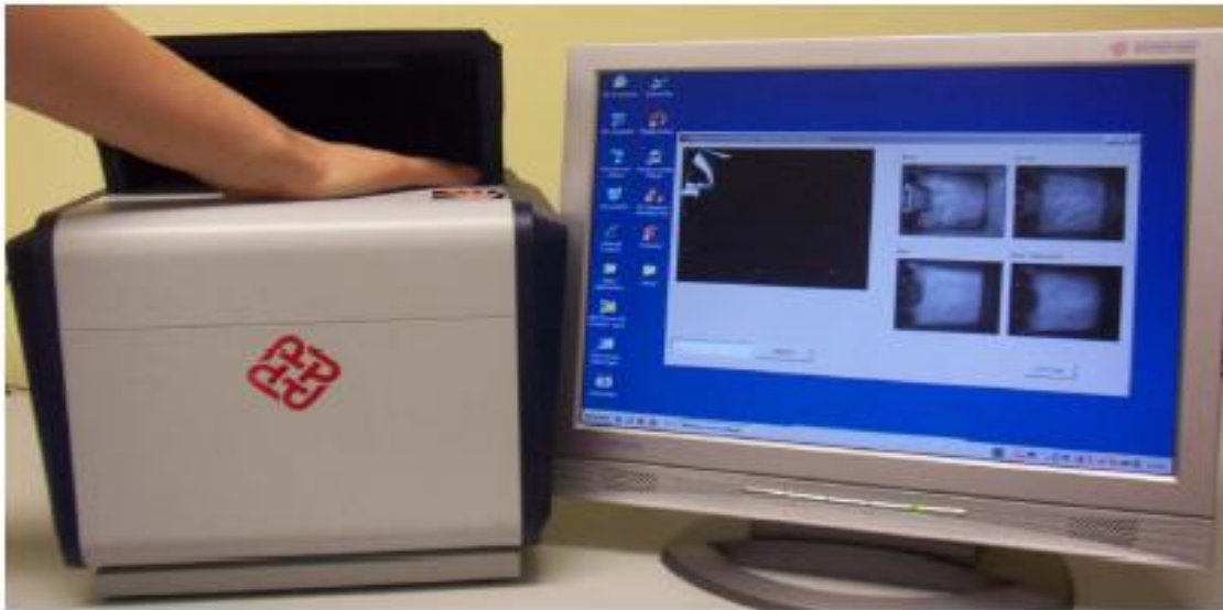
Figure 2.11 Structure externe d'un dispositif d'acquisition d'image palmprint multispectrale [75]
