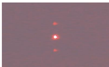
Figure. III.6.a : Profil d'intensité effectué sur l'image des ordres diffractés pour C = 10\% et une température T=18^\circ\text{C} ( d=102 pixel)
