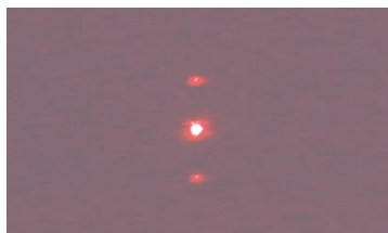
Figure. III.6.a : Profil d'intensité effectué sur l'image des ordres diffractés pour C = 10\% et une température T=18^\circ\text{C} ( d=102 pixel)
