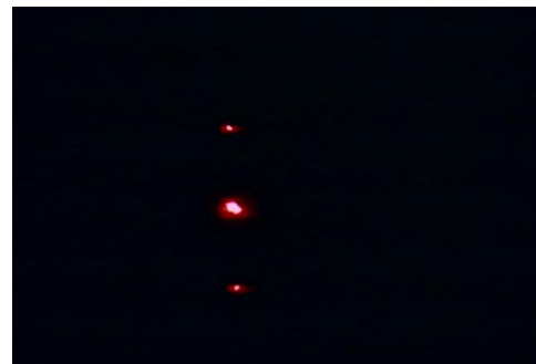
Figure III.21.b : Profil d'intensité effectué sur l'image des ordres diffractés pour une concentration C= 33% (eau distillée pure) à une température T21°C, distance mesurée d=106.5 Pixel
