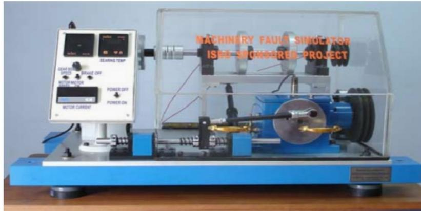
**Fig2.6-** Dispositif expérimental pour l'étude des défauts de roulement.
