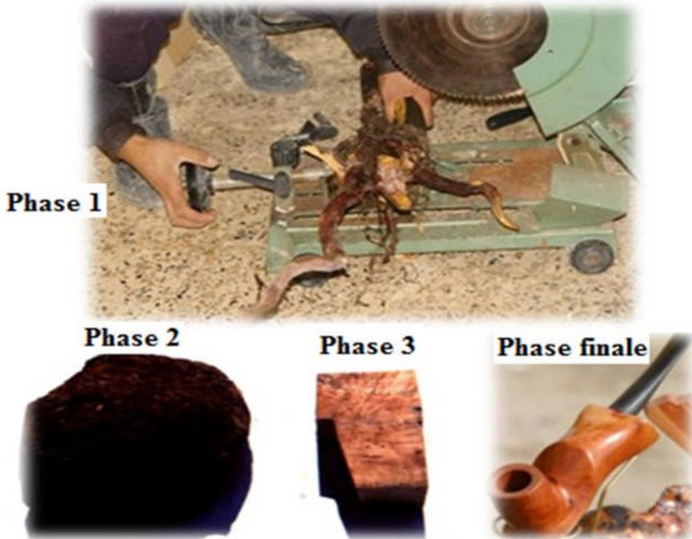
**Photos 60 : Phases de fabrication d'une pipe (Sarri 2011)**
