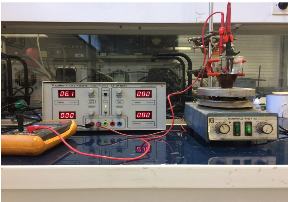
Figure 4 : Montage de la technique EPD.
