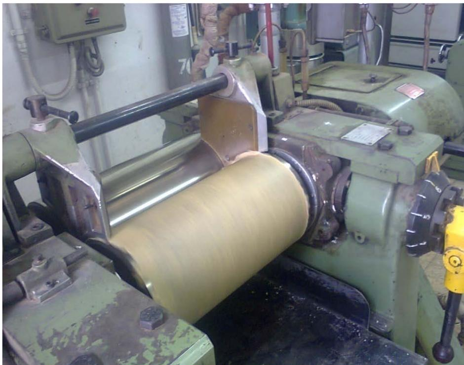
**Figure IV.1.** Préparation des composites PVC/GE sur un mélangeur à deux cylindres.
