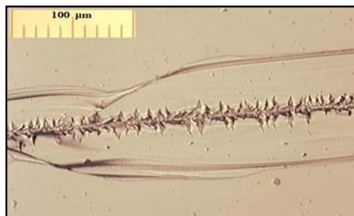
Fig.IV.3: Rayure sur un verre brut pour v = 10 \text{ mm/s} ; P = 2 \text{ N} .
