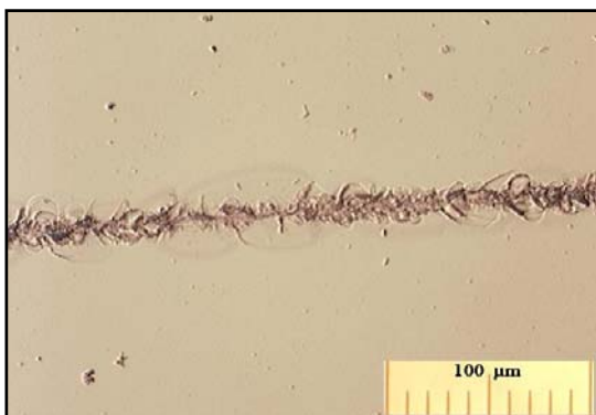
Fig.IV.16: Rayure sur un verre lubrifiée à l'eau, pour P = 1\text{N} ; v = 0.1\text{mm/s}
