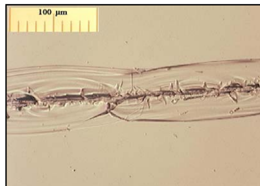
Fig.IV.17: Rayure sur un verre lubrifiée à l'eau, pour P = 1\text{N} ; v = 10\text{mm/s}
