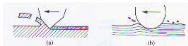
Fig.6 : Mécanisme de l'abrasion : (a) abrasion par effet de coupe ; (b) abrasion par déformation [20]
