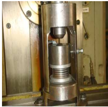
Fig. 6 : Dispositif d'indentation cyclique
