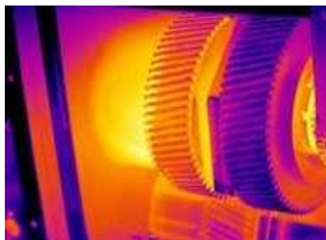
Figure 7.1 : image thermique d'un arbre à pignons. Source : « Eco-Energie services »
